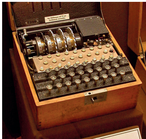
Abbildung 4. Enigma mit vier Rotoren (Enigma T „Tirpitz“)
